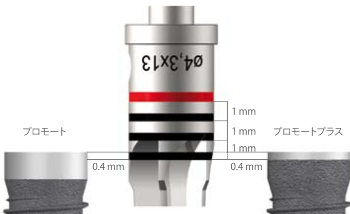
最初の目盛の下端は、デプスストップを装着した時のインプラント長に合致しています。
