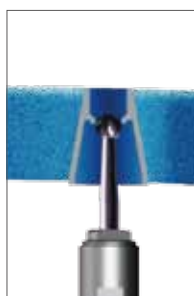
スクリーン内部の 固定用エッジの除去
